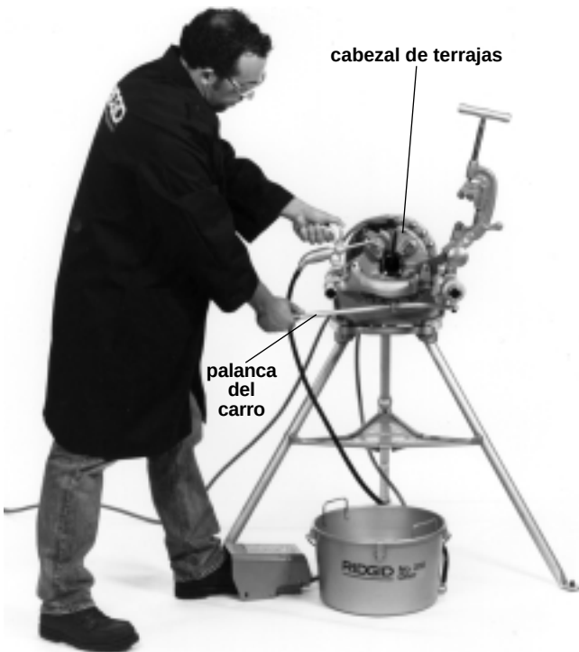
Figura 11 – Roscado de un tubo con un cabezal de terrajas de autoapertura o uno de apertura rápida
